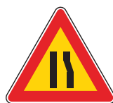
Fig. 386 strettoia asimmetrica a destra
