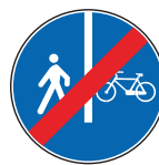
Fig. 93 a fine della pista ciclabile contigua al marciapiede
