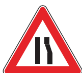
Fig. 19 strettoia asimmetrica a destra
